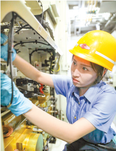
李韵茜对机车机械间内继电器螺丝进行防缓线检查。许伟摄
