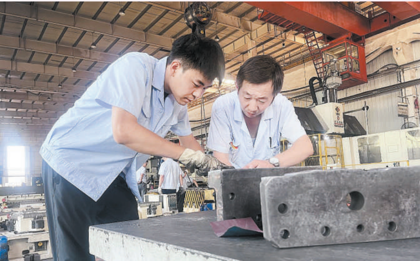
党金鑫（左一）与师傅正在对汽车装备厂模具进行修复。
