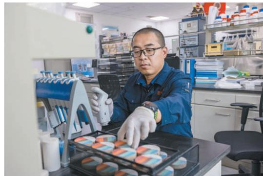
6月17日，甘肃敦煌，敦煌研究院保护研究所的刘颖颖在多场耦合环境模拟实验室进行土遗址劣化模拟试验。该实验室是我国文化遗产保护领域首个具备多场耦合环境模拟能力的科研设施，其模拟环境能覆盖我国绝大多数的文化遗产。 熊业腾/摄
