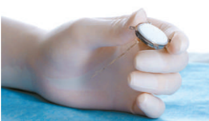
植入体直径26毫米、厚度不到6毫米，是全球最小尺寸的脑控植入体，仅硬币大小。
