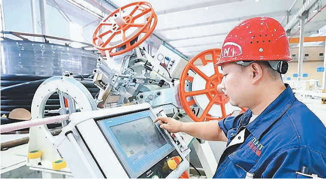
在宝鸡天联汇通复合管道有限公司生产车间，操作工罗龙飞在查看纤维预浸带复合缠绕设备运转情况。
