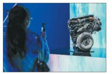
第五代 EA888 发动机应用了可变截面涡轮增 压器(VTG)、500bar超高压燃油系统、全工况最佳 油气比、全工况米勒循环、紧耦合排气净化装置等 先进技术,随着途昂Pro上市完成了全球首秀。
